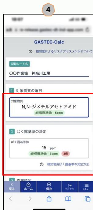
検知管用ばく露基準値が表示されます。未設定の物質は手動で入力してください。
