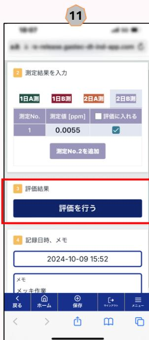
「2日A測」と「2日B測」の測定値を順番に入力します。全ての測定値の入力が完了したら、「判定を実施」をタッチします。
