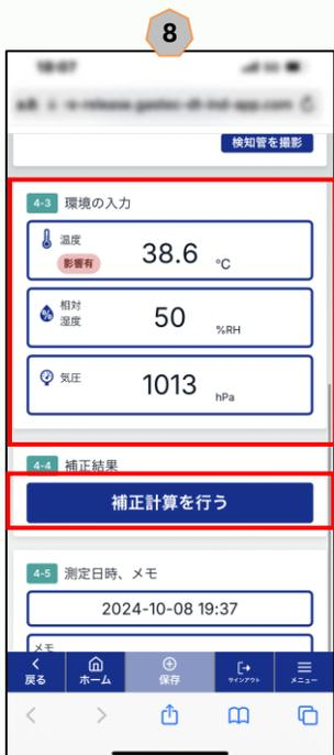
測定環境の温度・湿度・大気圧を入力します。「補正値計算を行う」をタッチします。
