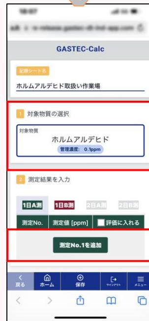
対象物質と管理濃度が表示されます。各測定点の測定値を入力します。「測定No.1」をタッチしてください。
