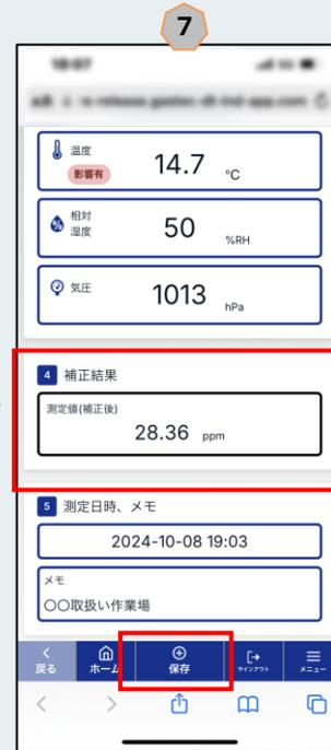
補正後の測定値が表示されます。メモを追加でき測定日時と合わせて保存できます。
