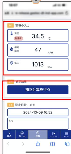
測定環境の温度・湿度・大気圧を入力します。「補正値計算を行う」をタッチします。
