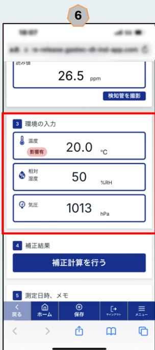
温度・湿度・大気圧を入力し、「補正計算を行う」をタッチします。
