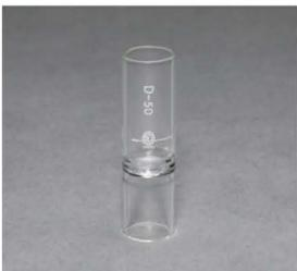
ディフュージョンチューブセット3100及び3200より大きな拡散速度が得られ、高濃度ガスの調製が可能です。ディフュージョンチューブ保持用二段かごPD23と併用します。
