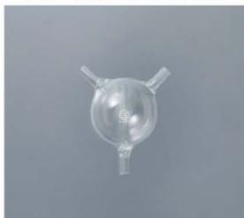
二つの流路で調製したガスを連続的に混合する、または、一つの流路で調製したガスを連続的に二方向に分岐します。
